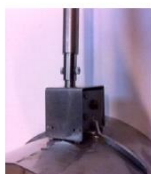
Monter montagestang på rottespærre og sørg for at den er spændt helt sammen (OFF) inden montage. Monteres rottespærren i plastrør, vippe de små gribere ud med tang
