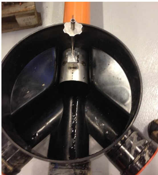
Foto 3. Placering af rottespærre i \varnothing 350 brønd, samt prøvning af fastholdelse af rottespærren under tryk.
