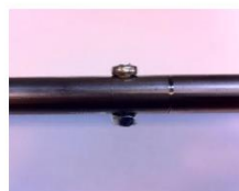
Tilpas montagestang til dybden på brønden ved at samle stængerne til den ønskede længde
