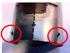
Monter montagestang på rottespærre og sørg for at den er spændt helt sammen (OFF) inden montage. Monteres rottespærren i plastrør, vippe de små gribere ud med tang
