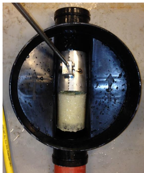
Foto 3. Placering af rottespærre i \varnothing 350 brønd, samt prøvning af fastholdelse af rottespærren under tryk.
