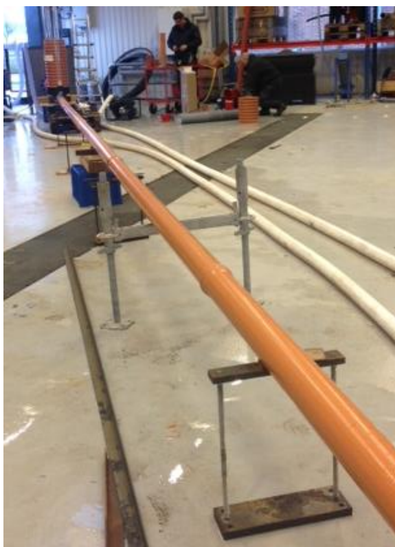
Foto 4. Forsøgsopstilling for test af enkelttab.
